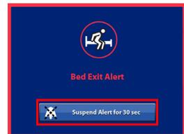
Pritisnite **Suspenduj upozorenje na 30 sek. (Suspend Alert for 30 sec)** na dodirnom ekranu, a zatim izaberite režim deaktiviranja upozorenja (v. „Izbor režima suspendovanja upozorenja“ str. 40).
