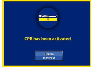
**i** La función CPR del colchón sólo funciona si el colchón está activo y su batería está completamente cargada (se tardan 24 horas en cargar la batería).
