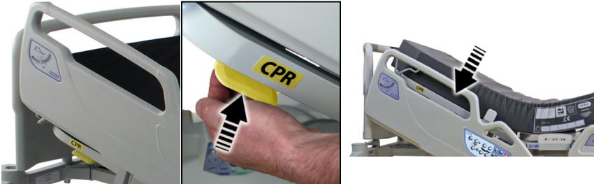
Mit einem Druck auf den CPR-Griff fährt die verstellbare Rückenlehne mechanisch zurück in die Flachstellung, richtet die Höhenverstellung an der höheren Seite aus und entlüftet die kombinierte Matratze\*.
