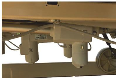
13. Coloque el quinto imán con un gancho de servicio en el centro del bastidor y fíjelo al bastidor en el lateral del mecanismo de accionamiento.
