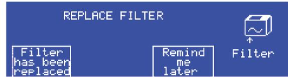
l'écran **Changer le filtre** (Replace Filter) apparaît pour vous rappeler qu'il faut changer les filtres. Pour remplacer les filtres plus tard, appuyez sur **Me le rappeler ultérieurement** (Remind me later). Quand vous remettez l'unité d'alimentation en air en marche, l'écran **Changer le filtre** (Replace Filter) s'affichera.
