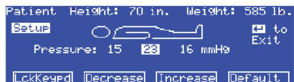
3. L'unité ajuste automatiquement les points de pression pour la taille et le poids définis. Si besoin, utilisez les flèches pour déplacer le curseur sur le paramètre des points de pression applicable ; tête, assise ou pied, et ajustez les paramètres comme suit :
