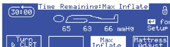
Si l'appareil est en mode Gonflage maximal (Max Inflate) pendant 29 minutes, l'alarme retentit et l'écran du décompte de 1 minute apparaît :
