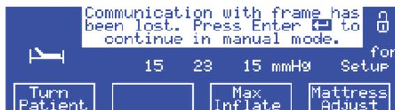
Si le système remplit les trois conditions ci-dessus et que les extensions de largeur électriques ne fonctionnent toujours pas, l'unité d'alimentation en air peut faire l'objet d'une erreur du tableau de communication interne. Si tel est le cas, le message **Erreur de communication** (Communication Error) apparaît.
